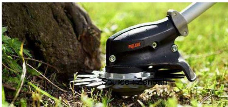
Le **Réciprocator**<sup>®</sup> ou le **city-cut**<sup>®</sup> sont des débroussailleuses à disques permettant de tailler la végétation en toute sécurité le long des bordures, autour des arbres sans risque de projection et sans abîmer les clôtures et les troncs d'arbres.
